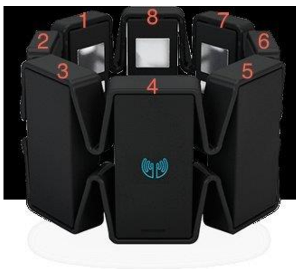
ΕΙΚΟΝΑ 16. ΤΑ ΟΚΤΩ ΗΛΕΚΤΡΟΔΙΑ ΤΟΥ ΜΥΟ ARMBAND
