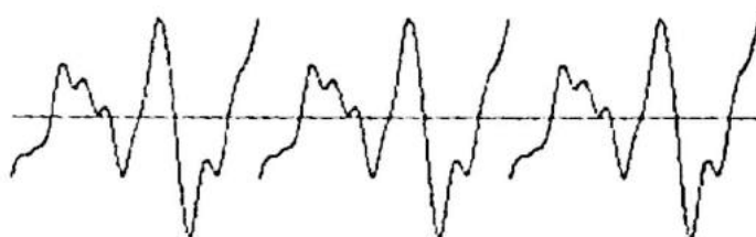
(σχήμα 3.8) Συγκολλημένοι ηχητικοί κόκκοι που έχουν ασυνέχειες στην κυματομορφή γιατί δεν τους έχει επιβληθεί περιβάλλουσα.
