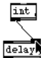
Σχήμα 19. Ένωση δύο αντικειμένων. Η είσοδος του αντικειμένου που λαμβάνει τις πληροφορίες μεγεθύνεται.
