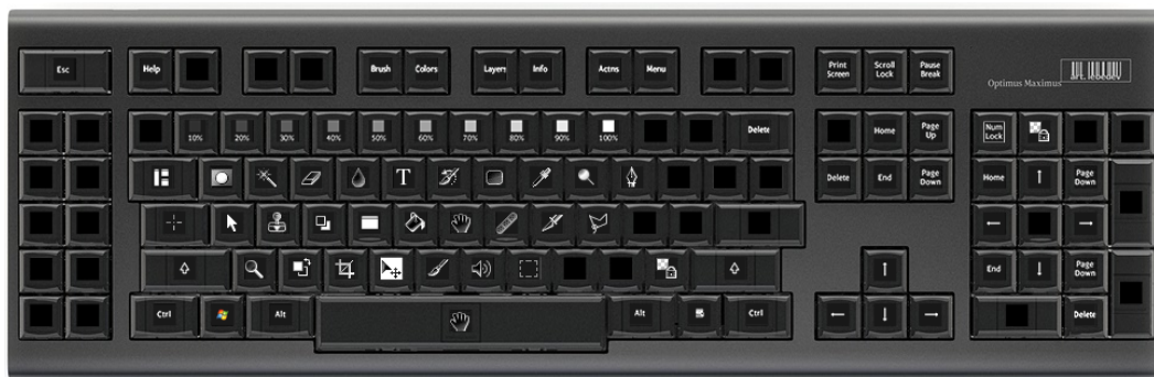
Σχήμα 2.2: Πληκτρολόγιο σε διάταξη Photoshop.
