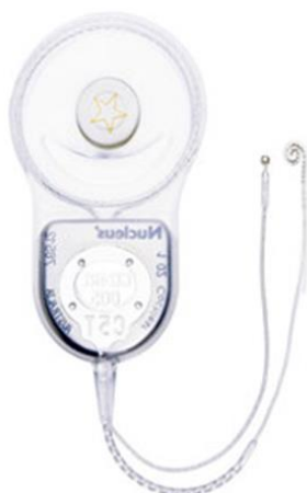
Εικόνα 4: Εσωτερικό τμήμα ΚΕ – Ο εσωτερικός κυκλικός δέκτης και η συστοιχία των ηλεκτροδίων (Κυριαφίνης, 2023).
