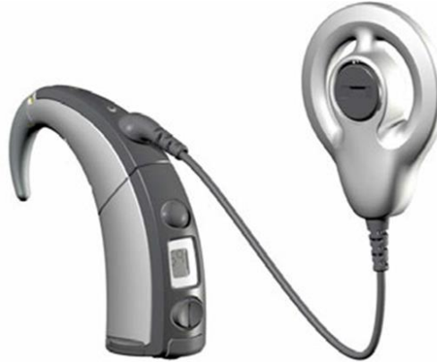
Εικόνα 3: Εξωτερικό τμήμα ΚΕ – Αριστερά πάνω τα μικρόφωνα, κάτω τα κουμπιά χειρισμού και δεξιά το κυκλικό πηνίο του πομπού (Κυριαφίνης, 2023).
