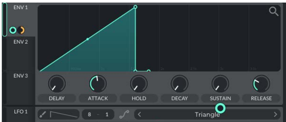
Εικόνα 28 περιβάλλουσα ελέγχου του formant φίλτρου.
