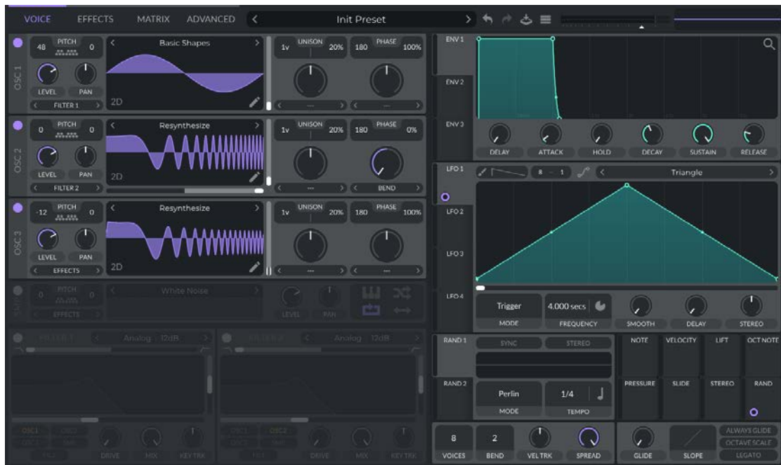
Εικόνα 23 όλα τα βήματα επανασύνθεσης για την κατασκευή του τελικού ταλαντωτή που φαίνεται στον OSC 3
