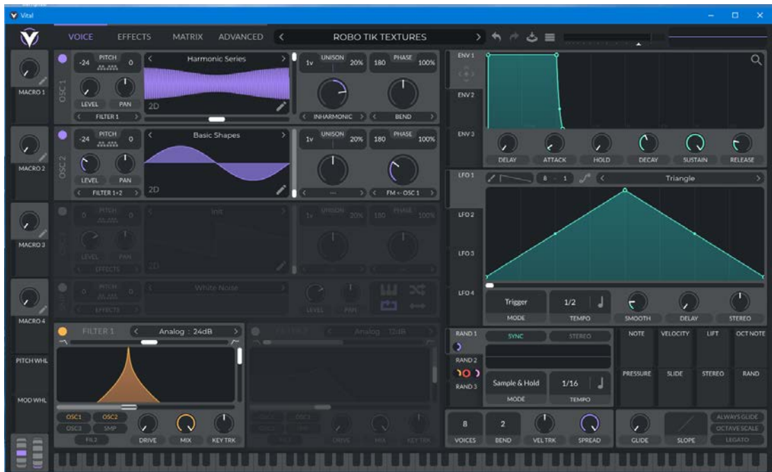
Εικόνα 21 ολοκληρωμένο πρόγραμμα συνθεσάιζερ όπου έγινε χρήση του wavetable «harmonic series» σαν διαμορφωτής στον ταλαντωτή OSC2 ο οποίος είναι ένα απλό ημίτονο.
