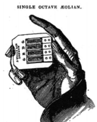
Εικόνα 15. Ο πιο απλός τύπος aeolina μονής τεσσάρων ελασμάτων. Λέγεται και aeolina οκτάβας. Οι φθόγγοι που φαίνονται είναι σολ σι ρε σολ(συγχορδία οκτάβας). Φωτο. και πληροφορίες από: α) Instructions for The Aeolina, New York Bourn Depository of Art 1830: 13, β) Worrall 2010: 4 γ) The Galpin Society Journal LXII 2009: 236
