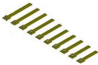
Εικόνα 3α. Τα φωνητικά γλωττίδια (Stimmzunge). Τοποθετούνται από την κεφαλή τους στις εγκοπές της φωνητικής πλάκας με ένα πριτσίνι. Το κάτω μέρος πάλλεται ελεύθερα.
