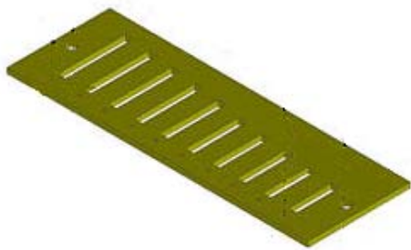
Εικόνα 2. Η φωνητική πλάκα (Stimmplatte). Διακρίνονται οι εγκοπές (Stimmzungeschlitze) με την επίσης κλιμακοειδή κατάταξή τους. Είναι κι αυτές 10 στον αριθμό, όσες δηλ. κι οι αύλακες στο «σώμα» του οργάνου.
